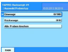
Hauptmenü mit der Auswahl Proben einzuwiegen, eingewogene Proben zurück-zu-wiegen oder alle Proben, die sich noch im Speicher befinden zu löschen (Proben bleiben im Speicher der Waage erhalten, solange sich noch nicht gedruckt wurden).
