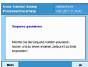
Es ist möglich eine Chromeleon™ Sequenz pausieren zu lassen und sie später weiter zu bearbeiten. Im Hauptmenü der Anwendung kann die Chromeleon™ Sequenz nun unter „Pausierte Chromeleon Sequenzen...“ gefunden werden.
