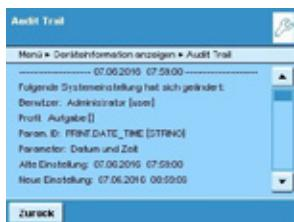
Wenn die Abweichung der Zeit zwischen NTP Server und Waage größer ist als 2 Sekunden, wird die Uhrzeit bzw. das Datum automatisch geändert und ein Audit Trail Eintrag erfolgt.
