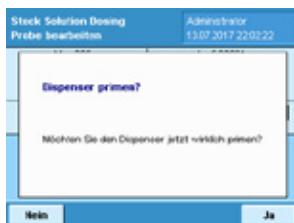
Für den Hamilton Dispenser speichert YAPP16 ob a) das Instrument richtig geprimed wurde, um frei von Luftblasen zu sein und die Spritze zu befüllen und ob b) die Restmenge an Lösungsmittel in der Spritze ausreicht, um den nächsten Dispensierschritt ausführen zu können. Wenn das nicht der Fall ist, wird dem Anwender eine Meldung mit der Frage angezeigt, ob das System geprimed werden soll.
