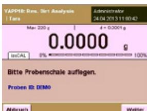
Nach Eingabe der Proben ID erfolgt die Aufforderung eine Probenschale aufzulegen. Das Taragewicht wird bei Betätigen der Weiter Schaltfläche übernommen und die Anzeige auf Null gesetzt.
