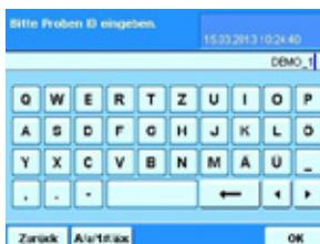
Nach Betätigen der Einwaage Schaltfläche erfolgt die Aufforderung eine Proben ID einzugeben (alphanumerisch)
