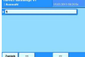
Nach Betätigen der Rückwaage Schaltfläche erfolgt eine Auswahl aller eingewogenen Proben und kann durch Betätigen zur Rückwaage ausgewählt werden.
