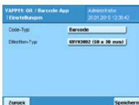
Ab Werk ist die Applikation auf den Typ Barcode und Endlospapier parametert.
