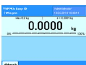
Befindet sich nach der Eingabe der ID's nichts auf der Waagschale, ist die ID, sowie GLP Ende Taste nicht sichtbar.
