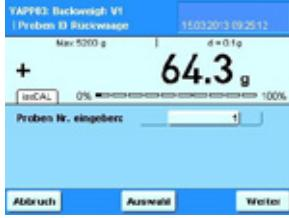
Nach Betätigen der Rückwaage Schaltfläche erfolgt die Aufforderung eine Proben Nummer einzugeben.
