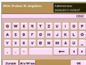
Nach Betätigen der Einwaage Schaltfläche erfolgt die Aufforderung eine Proben ID einzugeben (alphanumerisch)
