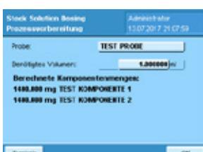
Das benötigte Gesamtvolumen der Stammlösung muss eingegeben werden. Das finale Volumen darf nicht größer sein als die Kapazität des verwendeten Gefäßes
