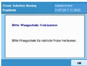
Um mir der nächsten Probe einer Chromeleon™ Sequenz fortzufahren sollte die Waagschale frei geräumt werden. Dem Anwender wird eine entsprechende Meldung angezeigt.
