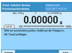
Platzieren Sie ein geeignetes Gefäß auf der Waagschale und drücken Sie „Tarieren“, um die Waage zu tarieren.
