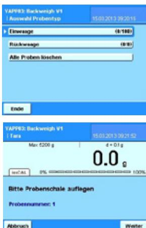
Hauptmenü mit der Auswahl Proben einzuwiegen, eingewogene Proben zurück-zu-wiegen oder alle Proben, die sich noch im Speicher befinden zu löschen (Proben bleiben im Speicher der Waage erhalten, solange sich noch nicht gedruckt wurden).
