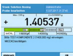
Für Mischstandards wird der Prozess solange mit dem Einwiegen der nächste Komponente fortgesetzt, bis alle Komponenten durch den Anwender eingewogen wurden.
