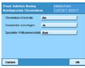
Chromeleon™ Anwender müssen die Chromeleon™-Kontrolle des Cubis Dosing Systems aktivieren. Chromeleon™-Kontrolle ermöglicht es der Software Daten an die Waage zu senden und abzuholen.
