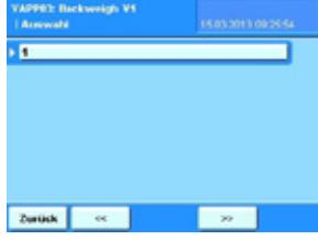
Alternativ wird nach Betätigen der Auswahl Schaltfläche eine Auswahl aller eingewogenen Proben Nummern angezeigt und kann durch Betätigen zur Rückwaage ausgewählt werden.
