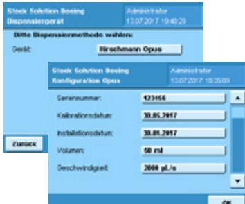
Für den Hirschmann opus Dispenser müssen das Volumen und die Geschwindigkeit festgelegt werden. Drücken Sie „Konf.“ im Auswahlbildschirm für Geräte. Die Geschwindigkeit kann zwischen 1.000 µl/s und 10.000 µl/s gewählt werden. Die maximale Geschwindigkeit unterscheidet sich für opus Dispenser mit unterschiedlichen Volumina:
