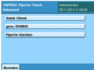
Wählen Sie im Hauptmenü zwischen den beiden Testmethoden **Quick Check** und **gem. ISO8655**. Der Unterschied besteht in der Anzahl Ihrer Messungen. Beim **Quick Check** führen Sie bis zu 9 Messungen, bei einer Prüfung **gem. ISO8655** 10 Messungen durch.
