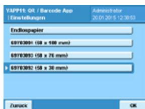
Die Auswahl des Druckerpapiers kann unter Etiketten- Typ festgelegt werden. Zur Auswahl steht: Endlospapier und Selbstklebende Etiketten von der Größe: 58 x 100mm, 58 x 76 mm und 58 x 30 mm.
