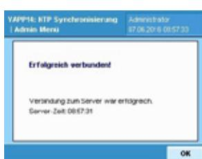
Über die Taste ‚Test‘ kann die Verbindung zum NTP Server überprüft werden. Hier wird lediglich die Verbindung überprüft eine Synchronisierung wird hier noch nicht vorgenommen.
