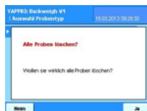
... erfolgt eine Betätigungsabfrage. Wird diese mit Ja bestätigt, werden alle im Speicher der Waage abgelegten Proben gelöscht.
