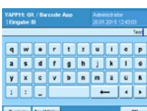
Nachdem die IDs eingegeben worden sind, werden sie über **OK** auf dem YDP30 Drucker ausgegeben.
