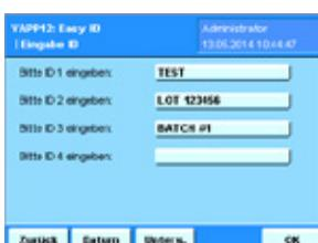
Es können bis zu 4 unterschiedliche IDs eingegeben werden, die über den Button „Ok“ gedruckt werden. Über „Datum“ wird das aktuelle Datum und Uhrzeit ausgegeben. Mit dem Button „Unters.“ wird ein weiteres Unterschriftenfeld gedruckt. Über „Zurück“ gelangt man in den Einwägemodus.
