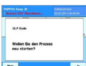
Mit dem „GLP Ende“ Button (siehe erste Abbildung) kann der Prozess beendet, und das GLP Protokoll abgeschlossen werden. Der direkte Neustart kann durch drücken des „Ja“ Button in dieser Abbildung erfolgen. Durch drücken des „Nein“ Button gelangt man in das Task Menü.
