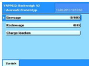
Chargenmenü mit der Auswahl Proben einzuwiegen, eingewogene Proben zurück-zuwiegen oder alle Proben, die sich noch im Speicher befinden zu löschen (Proben bleiben im Speicher der Waage erhalten, solange sich noch nicht gedruckt wurden).
