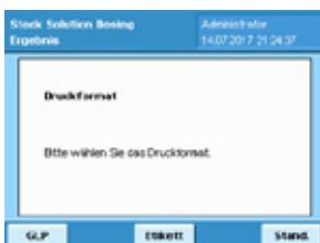
Die Anwendung kann GLP oder Standard Ausdrucke erstellen. Drücken Sie „GLP“ oder „Stand.“
