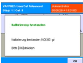
Bei Stillstand wird der Kalibrierwert automatisch übernommen und das Ergebnis angezeigt. (Schritt 3)
