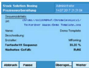
Der Fortschritt der Chromeleon™ Sequenz wird als Prozentwert angezeigt. Der Anwender kann mit der nächsten Probe weiter machen, eine Probe überspringen, abbrechen oder die Sequenz pausieren lassen.
