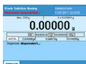
Das Lösungsmittel wird automatisch der Probe hinzugefügt. Während des Dispensierschritts wird dem Anwender die Meldung „Dispenser dispensiert“ gezeigt.
