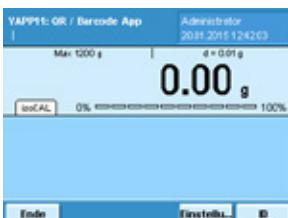
Über den Button **ID** wird die Eingabemaske für den Inhalt des Codes aufgerufen.
