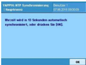
Falls ein Benutzer ohne Administratorenrechte angemeldet ist, besteht für diesen nur die Möglichkeit die Q-App zu starten, aber nicht selbst zu beenden. Während der Synchronisierung sind alle Tasten, bis auf On/Off gesperrt. Dies ist für ein automatisches Starten über eine Zeitgesteuert Funktion sehr hilfreich.
