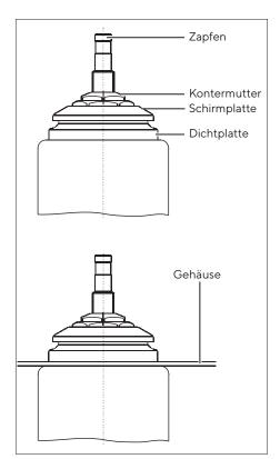
Eine oder auch mehrere Wägezellen können zu ihrem Schutz bzw. zur weiteren Verbesserung der Reinigungssituation mit einem zusätzlichen Gehäuse versehen werden.
