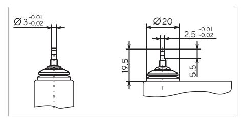
Auf diesen Zapfen kann der Lastaufnehmer z.B. durch Klemmung angebracht werden. Der Lastaufnehmer sollte aus leitfähigem, unmagnetischem Material bestehen um elektrostatische und magnetische Einflüsse zu minimieren. Das Gewicht des Lastaufnehmers muss 5 g  $\pm$  0,1 g betragen, damit der volle Wägebereich von 20 g zur Verfügung steht. Zusätzliche Vollast muss kleiner als 10 g sein, um die interne Justierung nutzen zu können. Bei einem Transport der Zelle den Lastaufnehmer entfernen.
