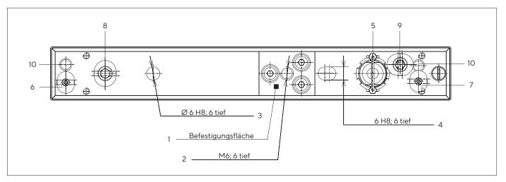
6 und 7 sind Sinterfilter.
